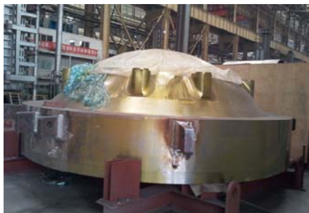
(1) 一体化顶盖（带垂直接管）
